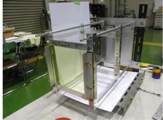
図 6 衝突試験ターゲットの構成
