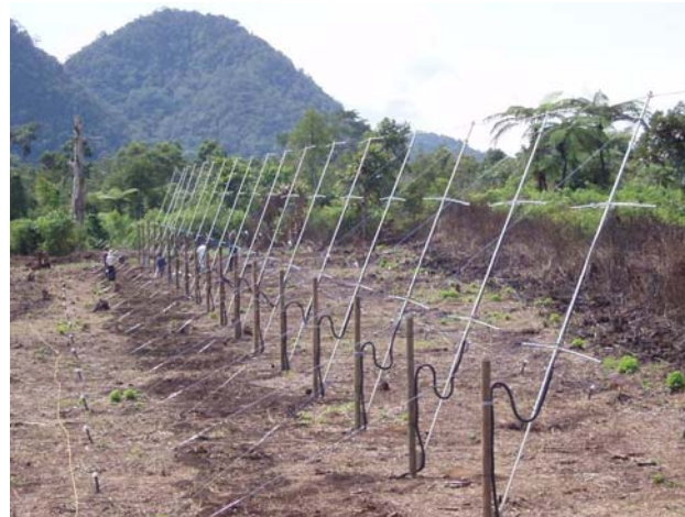
図 1: インドネシア・コタバンの赤道大気レーダーサイトに設置された 30.8MHz の VHF レーダー。
