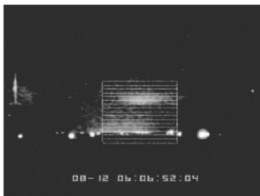
図 5. (左)スプライトの CCD 画像とアレイフォトメーターの視野. (右)アレイフォトメーターから推定した電子エネルギー.
