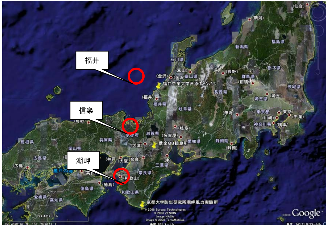
図 2 : ビーコン受信機の配置図。各点の間隔は約 150km である。衛星パスは南北に近いことトモグラフィ解析に適している。
