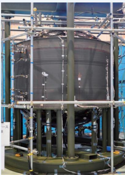
試作した2段モーターケースに水を入れて圧力をかける試験の様子
