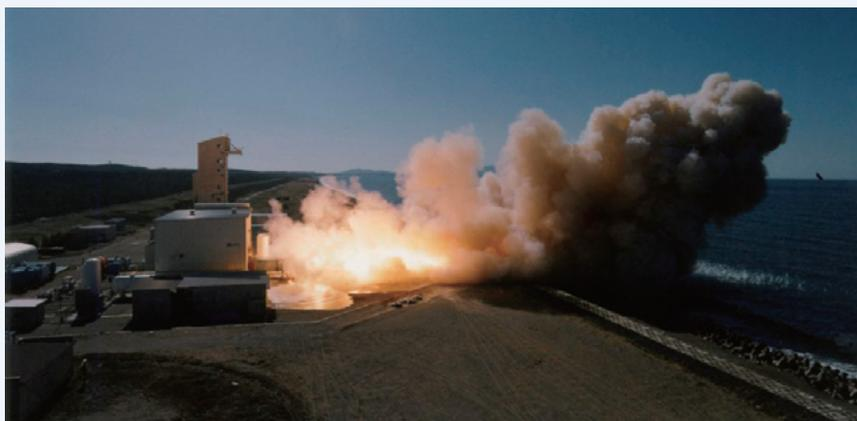
M-34真空地上燃焼試験の様子
