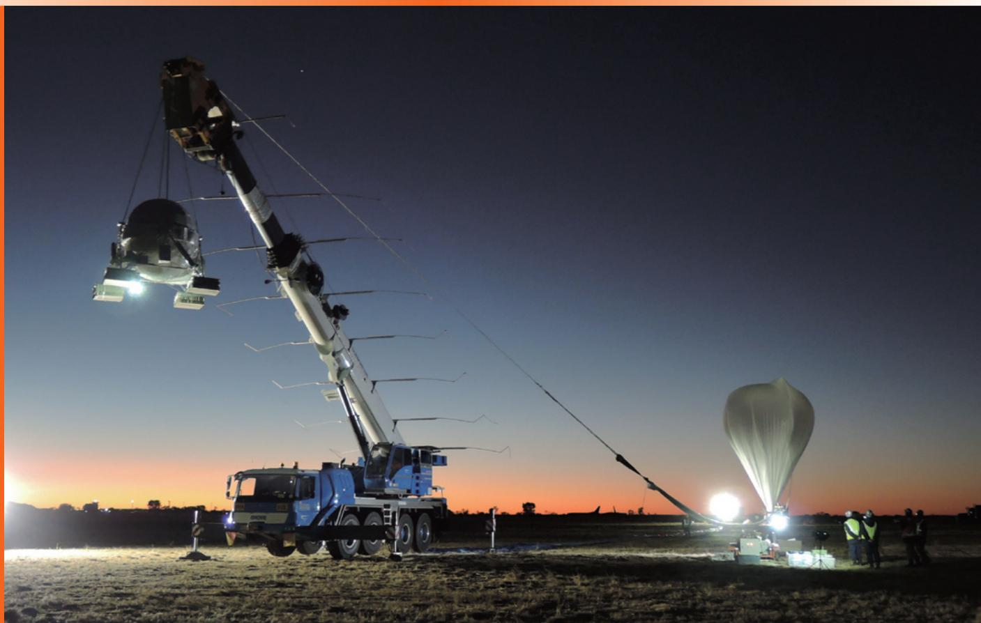
放球用クレーン車にセットされたエマルジョンガンマ線望遠鏡とヘリウムガスが充填された大気球。
