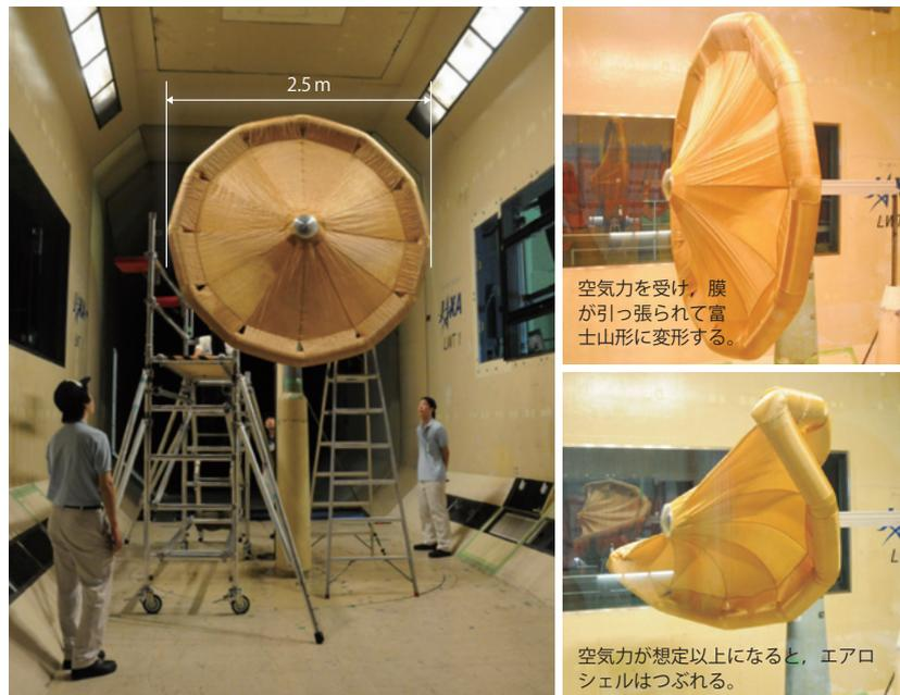
です。目標は、直径は2.5m、150kgの空気力に対して壊れることなく、100kW/m<sup>2</sup>程度の加熱に耐える柔軟なエアロシェルをつくることです。最後の加熱の条件がどれほどなのかを分かりやすく正確に表現するのは難しいのですが、表面温度が最大で1000℃程度の環境だと思ってください。つまり、表面が1000℃になっても空気が漏れない“風船”をつくるということです。
