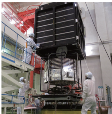
熱真空試験直後のBepiColombo MMOの全体像。試験中に探査機を覆っていたヒーターパネルから取り出しているところ。
