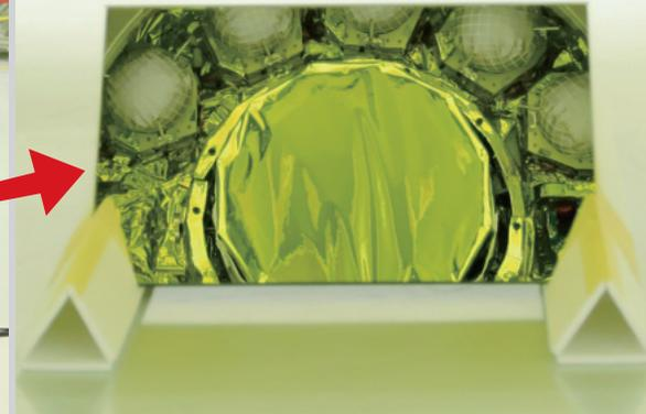
種子島宇宙センターで公開された小惑星探査機「はやぶさ2」。台車の下に置いた鏡を介して、探査機の下面に取り付けられた衝突装置と5個のターゲットマーカが見える。右上は、「はやぶさ2」に相乗りで打ち上げられる超小型深宇宙探査機PROCYONの組み立ての様子。
