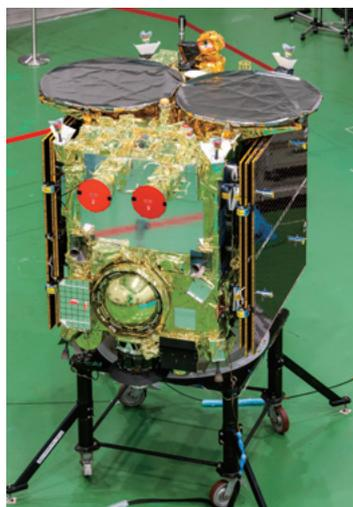
図1 「はやぶさ2」上に並んだXバンドアンテナ（左）とKaバンドアンテナ（右）
