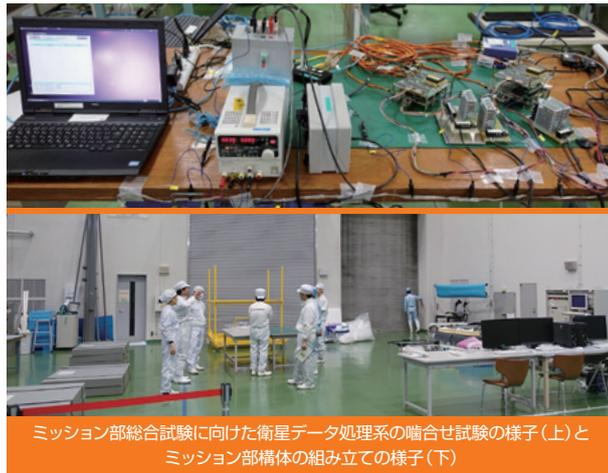
ミッション部総合試験に向けた衛星データ処理系の噛合せ試験の様子(上)と
