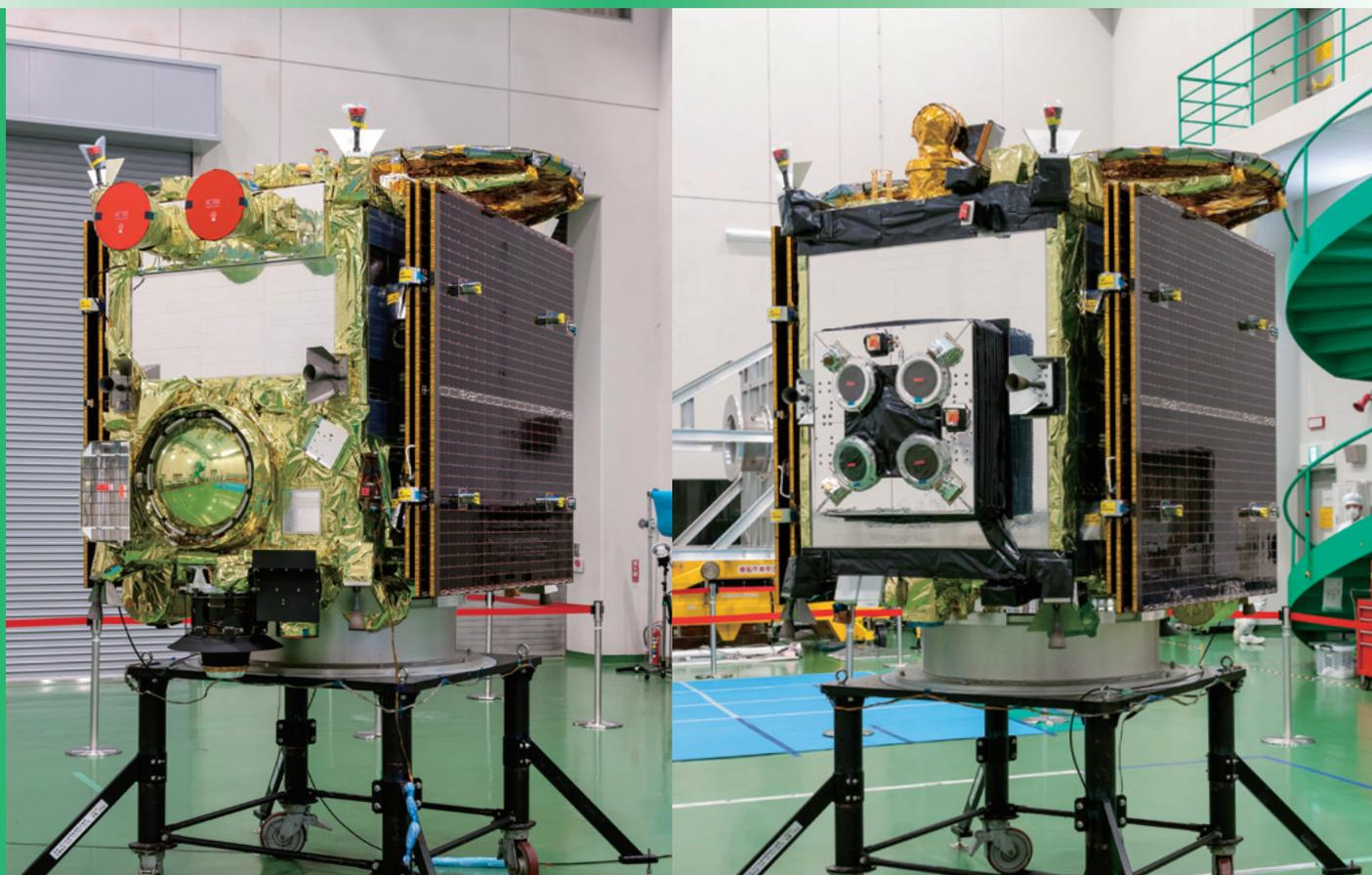
組み立てを終えて報道公開された小惑星探査機「はやぶさ2」。左の写真には再突入カプセル、右の写真にはイオンエンジンが見える。
