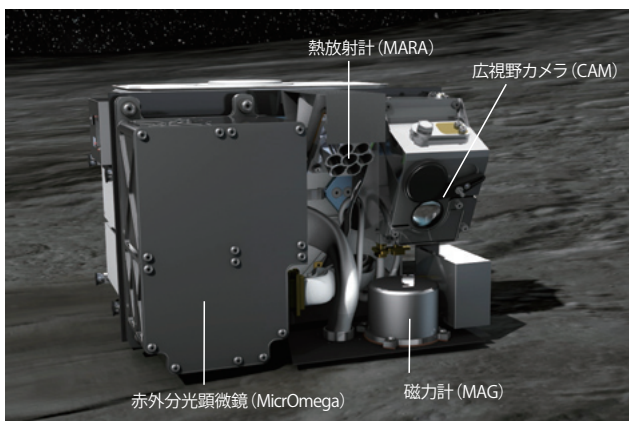
図1 MASCOT内部の観測機器 (提供: DLR)
