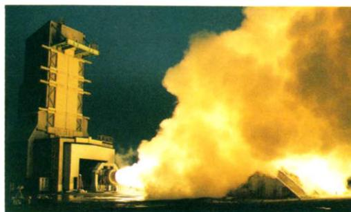
▲ M-Vロケット1段目の地上燃焼試験
