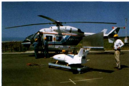
▲有翼飛翔体の滑空飛行実験▶
