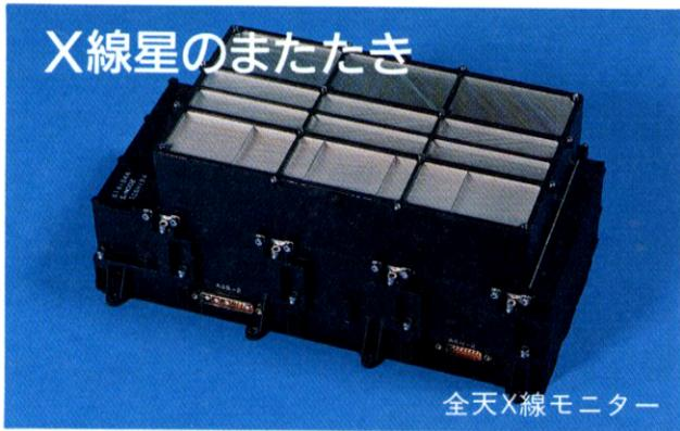
我々の目に見える星々は、いつの日にも変らぬ姿を見せますが、X線星の明るさの変化は激しく、日々その姿を変えと言っても過言ではありません。X線新星はその典型的な例でしょう。「ぎんが」は、大面積計数管の他に、長期間のX線星の明るさの変化を観測するために全天X線モニターを搭載しています。
