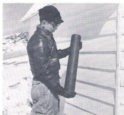
図2 ベビーロケット用ダブルベース推薬
