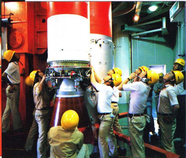
▶ 尾翼を尾翼筒にとりつける。尾翼の先端にはロール制御を司る SMRC (ロール制御用固体モータ) がある。
