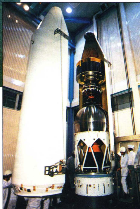
▶組立オペの時はダミーだった探査機も、今は本物にすげかえて、フェアリングをかぶせる。いよいよお別れだ。元気で行けよ！
