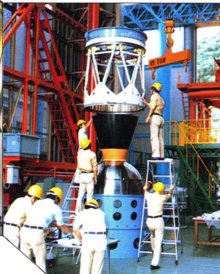
◀第2段上部におく基本計器部と第3段モータとを結合。
