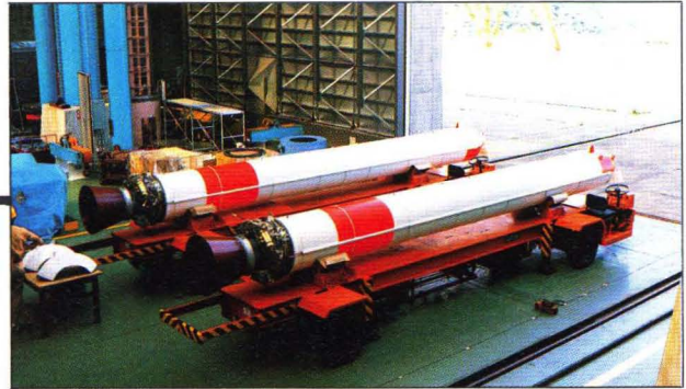
◀▶ 総合・地上系オペ後、推薬庫に保管されていた補助ブースタを組立室へ運ぶ。
