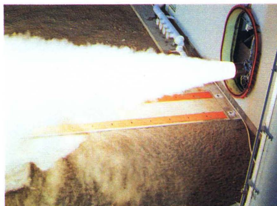
補助ブースタSB-735の燃焼実験(能代)
