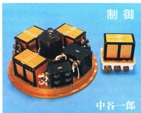
◀左図のうち、左側は2段目ペイロード部に搭載するジャイロおよび電子機器、右側は1段目ノズル回りに搭載する制御用電子機器
