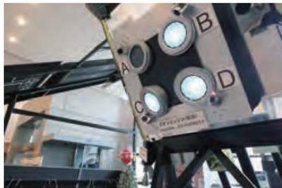
イオンエンジンは、イオン化したガスを電気ので加速して噴射する推進装置です。推進力は小さいものの燃費が桁違いに良いため、惑星間航行にはどうしても必要な技術でした。「はやぶさ」にはこのイオンエンジンが4基搭載されています。
