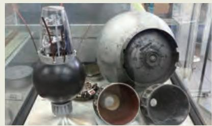
日本初の人工衛星「おおすみ」の1/2スケール模型(左)と、「おおすみ」と同型の予備機(L-4S-6)のモータ(右)
