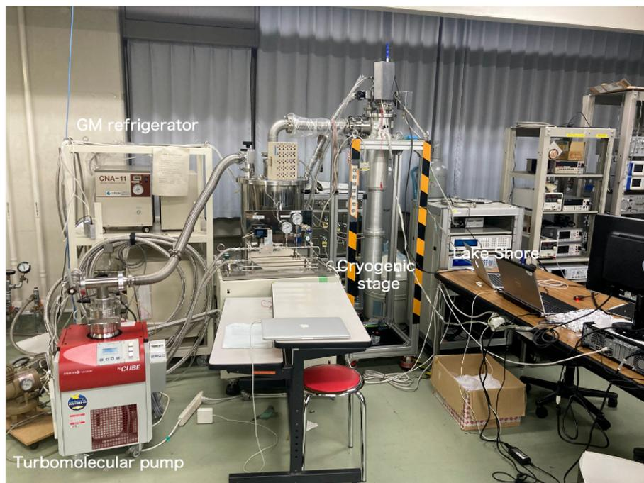
図 6.1. GM 冷凍機とターボ分子ポンプ。
