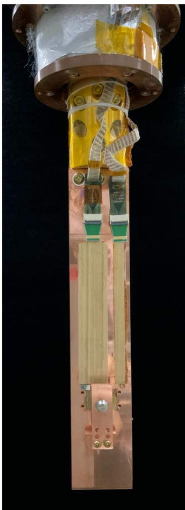
図 6.5. 冷凍機に極低温ステージを組み込んだ写真. 下部に X 線源と TES カロリメータが搭載されており、シール基板と冷凍機配線は上部の FPC コネクタにより接続されている。
