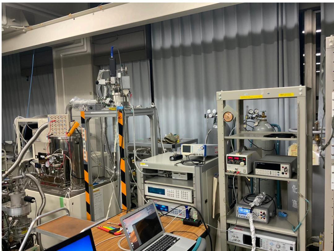
図 6.9.  $I$ - $V$  測定セットアップ. Magnicon からの出力を電圧計で読み出している.
