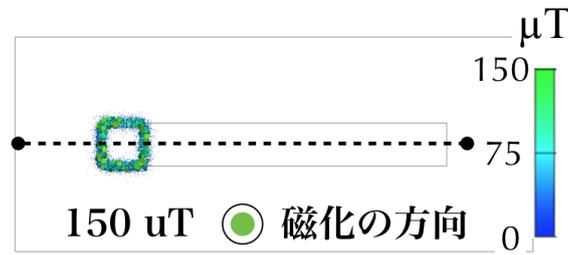
図 5.9 Fe を z 方向に磁化させた図
