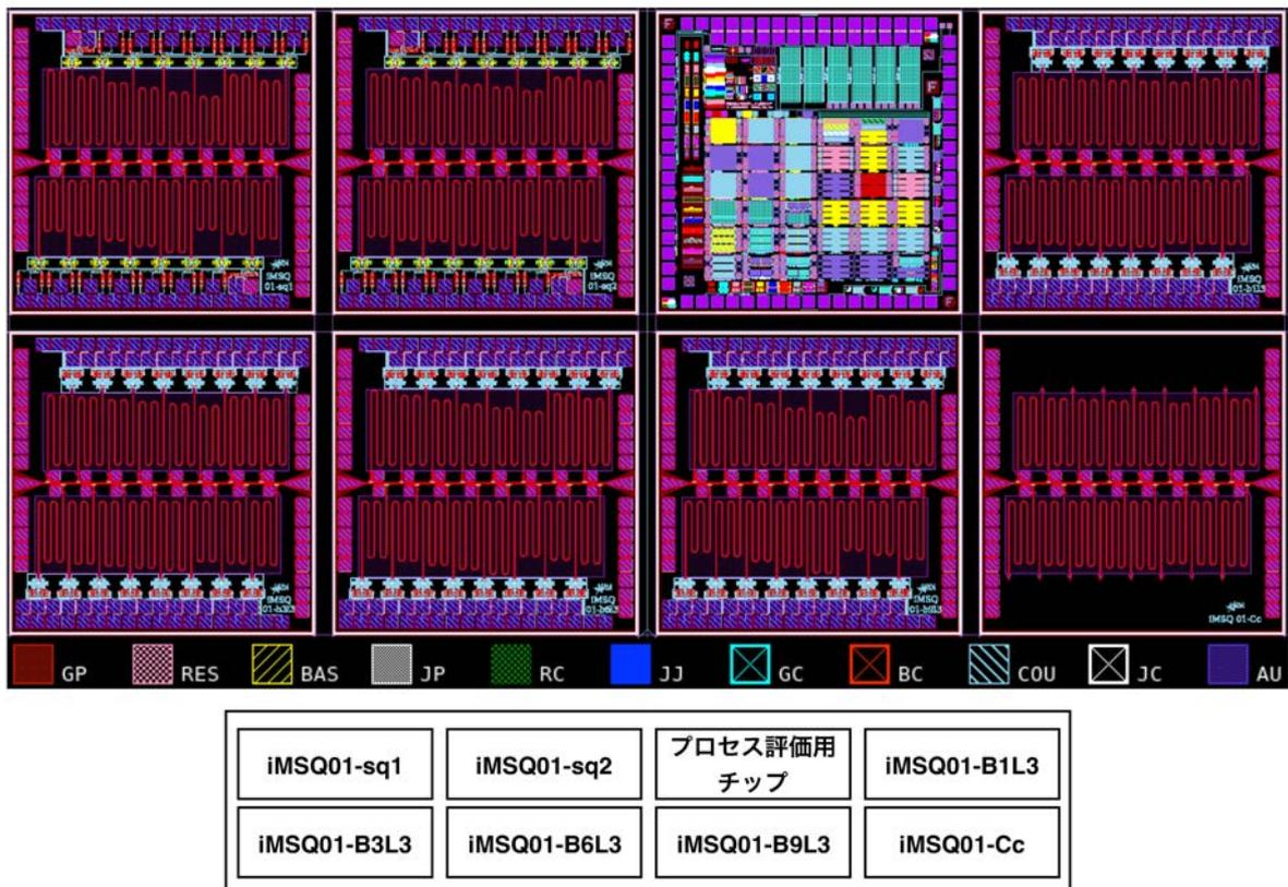
図 4.22 iMSQ01 のマスクレイアウト (トップセル)。設計した iMSQ01 に加えて、産総研に作成していただいたプロセス評価用チップのマスクレイアウトがある。
