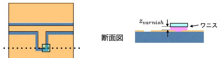
図 4.8: 素子を置いたときのイメージ(左)と点線での断面図(右)
