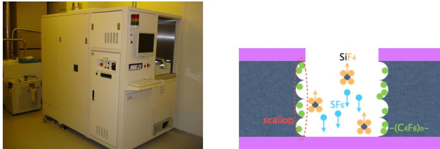
図 5.10 (左) 用いた DRIE 装置と DRIE のエッチング概略図
