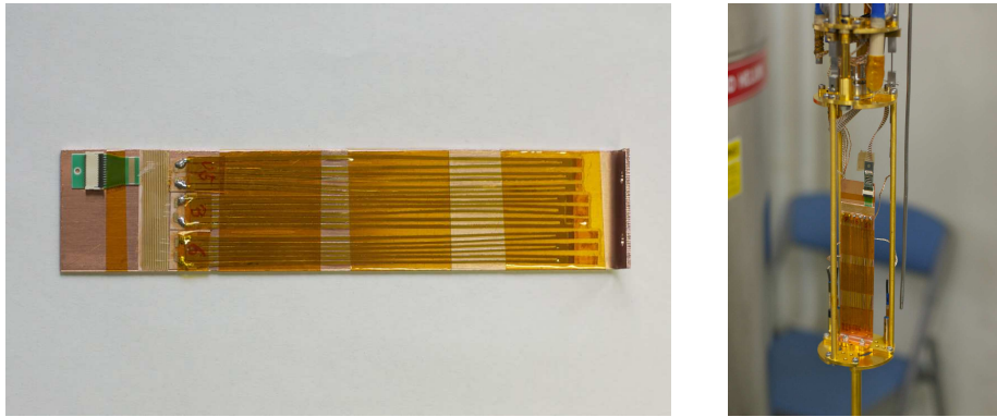
図 5.7 半田めっきシートの冷凍機へのマウント
