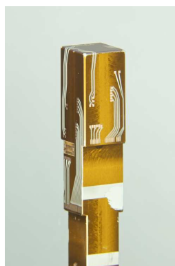
図 5.1 三次元超伝導配線を施したプローブ
