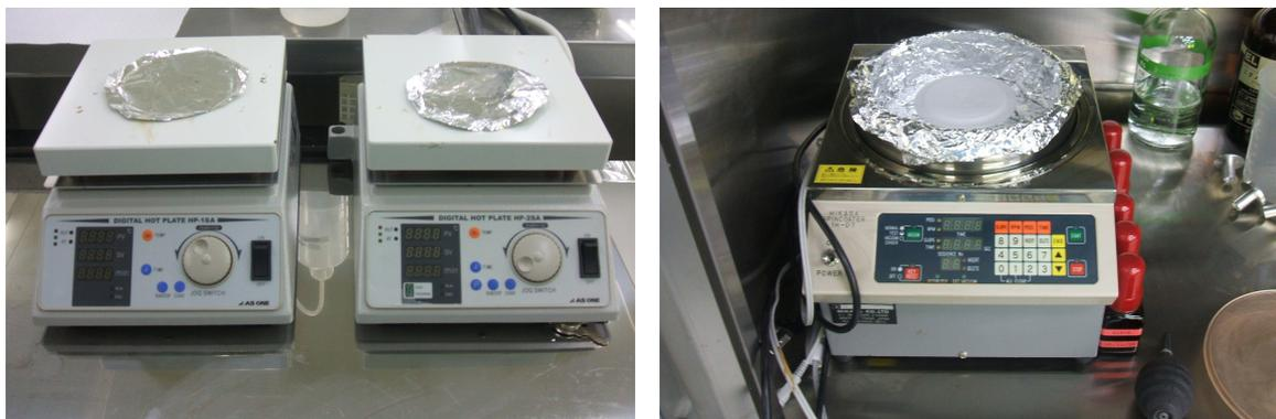
図 4.2: ホットプレート (左) とスピナー (右)。
