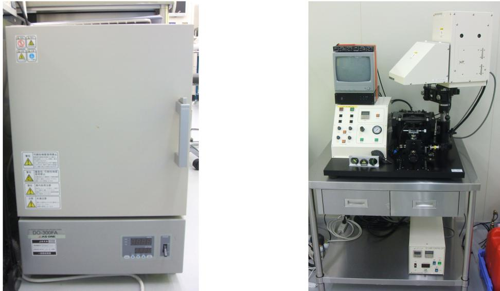
図 4.3: ベイク炉 (左) と UV 露光装置 (右)。
