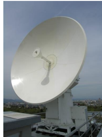
図 7 宇宙科学研究所の屋上に設置した S/X バンド共用アンテナ
