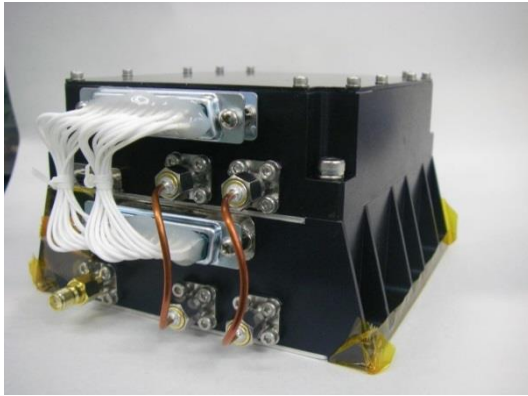
図 2 衛星搭載送信機のフライトモデルの外観
