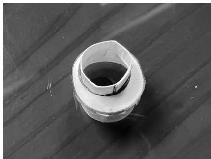
⑤ ②に③でサイズ調整した主反射鏡開口部中心立ち上がり部分を接着します。
