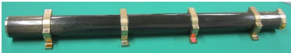
図 5.20. MTQ の写真。右端に駆動電圧を導入する D-sub 9 ピンコネクタがある。
