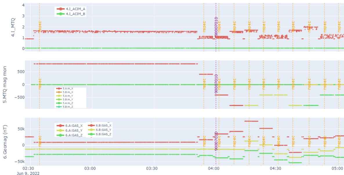
図 5.47. システム試験 (EMC 試験) 中の姿勢制御系 HK データ : 上段が MTQ 電流値、中段が MTQ 磁気モーメント、下段が GAS による測定磁場。B 系は冗長系であり、A 系を運用していた。
