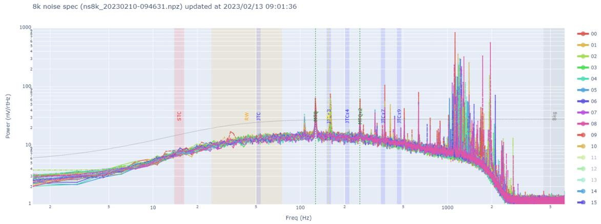
図 5.69. トレンディングケースの 8k noise spec (最終電気試験・B系 (x,y,z)=(+30, -30, +30)) : ピクセル 11, 12, 13 はクロストークの影響が表れているため除いている。
