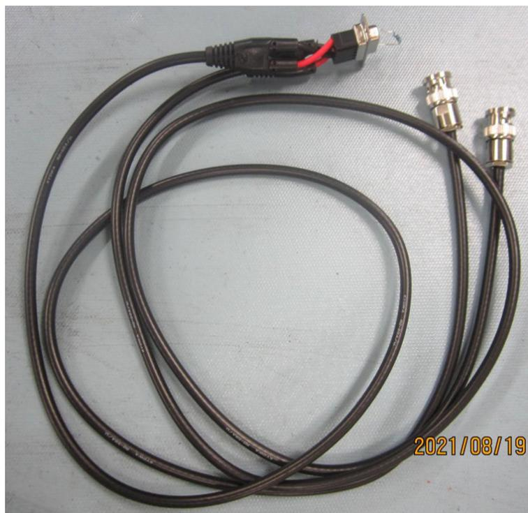
図 B.2. 各ソレノイド駆動用に自作した D-sub-BNC 変換ケーブル：ソレノイドは D-sub 給電口を持ち、各種機器は BNC 端子を持っていたため作成した。
