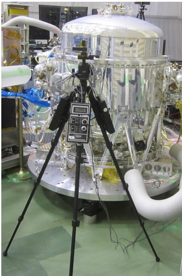
図 5.23. ガウスメータの配置：モニター部分は三脚の足、プローブは三脚の頭に固定している。
