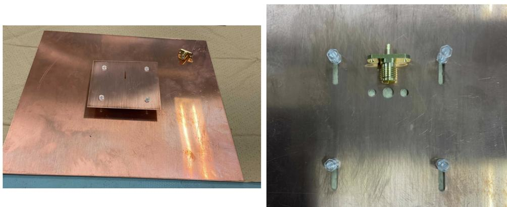
図 C.9. (左) グラウンド板の上にアンテナ板をポリカーポねじで固定した様子。給電部はついていない。(右) グラウンド板のねじスロット部分。インピーダンスマッチングのために可動式になっている。中央の穴は後ろから給電部を差し込むためのもの。
