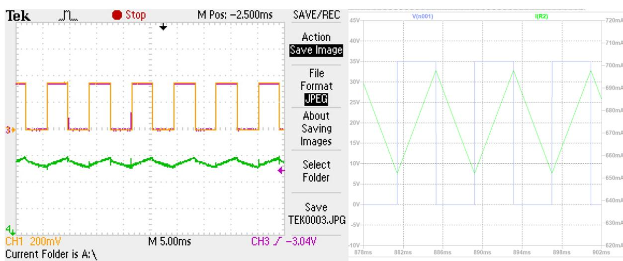
図 B.16. duty 比 50 PWM 入力の結果 (試験 2 MTQ) :左の y 軸のスケールは出力電圧 2 V(CH3)、電流 100 mA(CH4)。PWM の On/Off 切り替え時にスパイク構造が見られる。他は図 B.13 に同じ。
