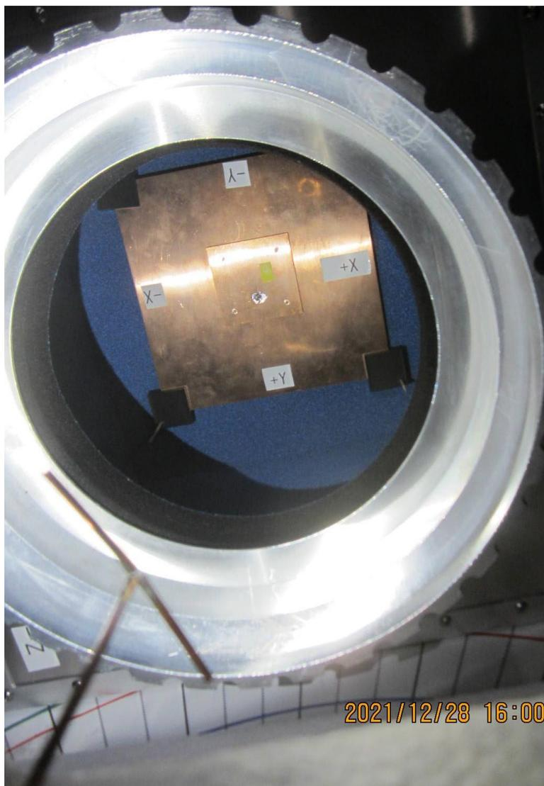
図 C.26. ゲートバルブ位置での電波強度測定
