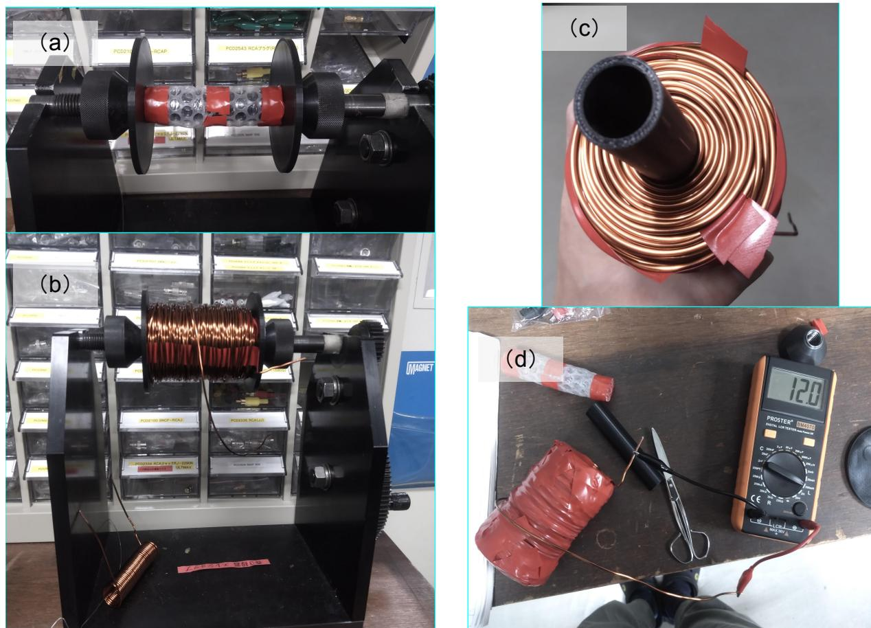
図 B.1. 自作ソレノイドの作成・測定: (a) 巻線器に 3D プリンターで製作した治具を取り付けた様子 (b) 銅線を巻き付けたあとの様子 (c) 芯の治具を引き抜いている様子 (d) インダクタンス測定の様子
