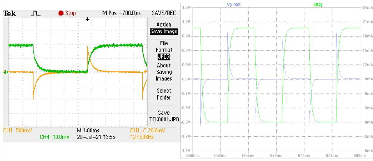
図 B.8. 矩形波入力の結果 (試験 1、自作ソレノイド) : 他は図 B.7 に同じ。
