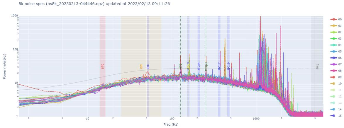
図 5.71. トレンディングケースの 8k noise spec (最終電気試験 CF モード・B 系  $(x,y,z)=(+30, -30, +30)$ ): ピクセル 11, 12, 13 はクロストークの影響が表れているため除いている。
