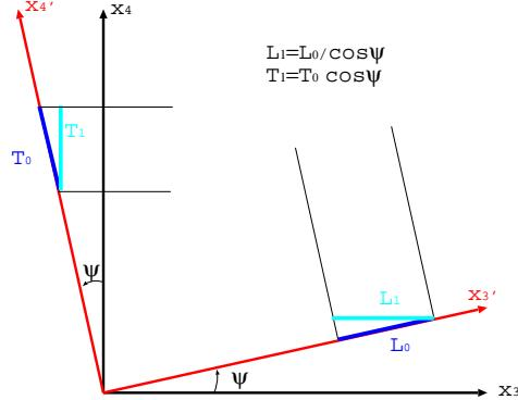
$K'$  系で、 $x'_3$  軸に沿った、長さ  $L_0$  の棒を考えよう。 $K$  系から見ると、この棒は  $+z$  方向に、速度  $v$  で走っていることになる。 $K$  でこの棒の長さを測るときには、当然同時刻で測るから、それは、 $x_3$  軸に沿った長さ  $L_1$  になる。図から、
