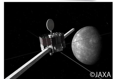
日欧協力の大型ミッション国際水星探査計画「ベピコロombo (BepiColombo)」でのJAXA担当の水星磁気圏探査機「みお」。水星の磁場・磁気圏の解明が主な目的です。
