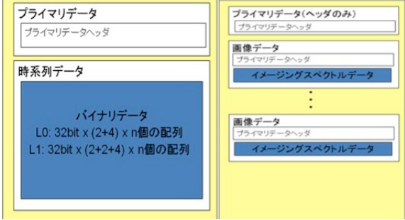
図 3: EUV の L0・L1 データフォーマット概念図 (左) と、L2 データフォーマット概念図 (右)
