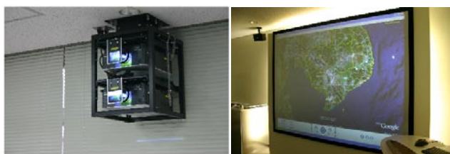
図2: 愛媛大学 Cyber Media Space ポータブルVRシステム用のデュアルDLPプロジェクタ (左) と120インチスクリーン (右)
