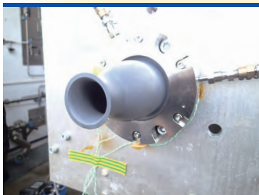
テストスタンドに取り付けられた1.1kN級セラミックスラスタ
