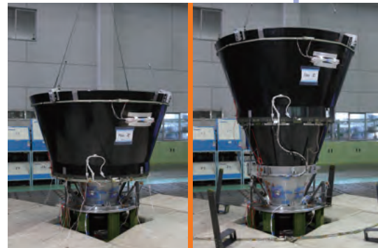
2段モータ伸展ノズル伸展試験の様子(左：伸展前、右：伸展後)
