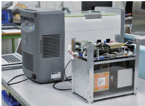
図1 超広角コンプトンカメラの試作機
