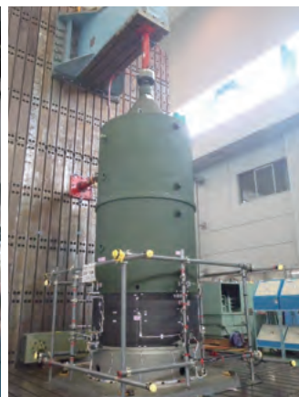
図3 3段モーターケース強度剛性試験
