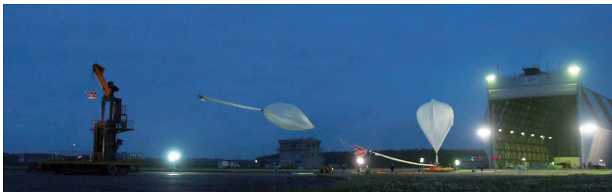
スライダー放球装置により屋外に移動された放球直前のタンデム気球
