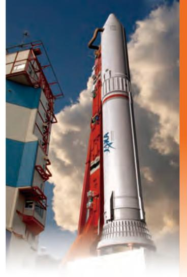
イプシロンロケットには、全段固体モータによる3段式の「基本形態」のほか、第3段の上にポスト・ブースト・ステージ (PBS) が追加された「オプション形態」が用意されています。PBSは、搭載された小型の液体推進系 (M-Vの姿勢制御用エンジン程度のコンパクトなもの) と航法誘導制御系により液体ロケット並みの軌道投入精度を実現させるステージです。M-V型ロケットまでは衛星側で行っていた軌道調整をロケット側の輸送サービスに含めることによって、多様なミッションへの対応能力と利便性を高めて需要の拡大を図ろうというわけです。
