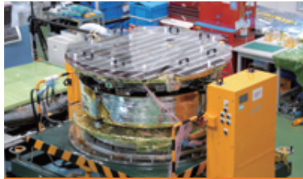
IKAROSの外観。円柱の本体の側面に差し渡し20mの正方形の帆が巻き付けられている。
