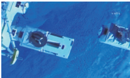
図1 移設中のSMILES (右) 左は「きぼう」の船外実験プラットフォームと全天X線監視装置 (MAXI)。
