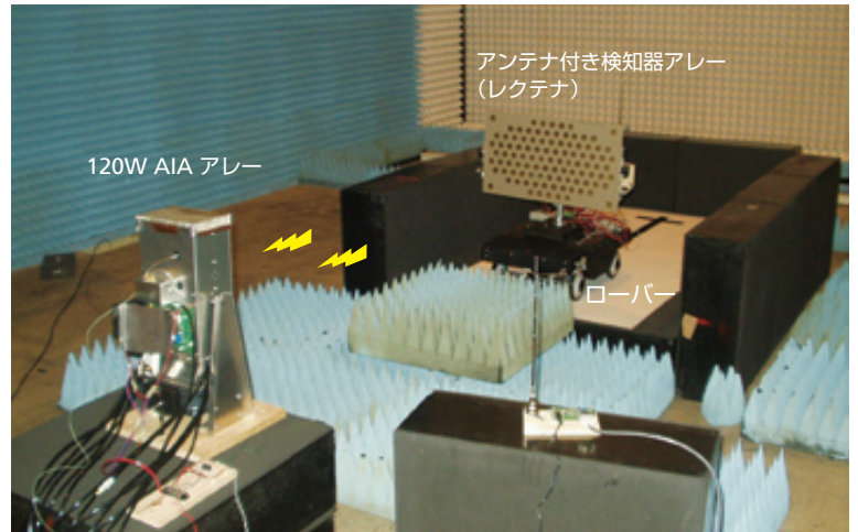
図4 ローバーへの無線エネルギー伝送実験 (財団法人宇宙実験システム研究開発機構と京大生体圏研究所などの協力による)
