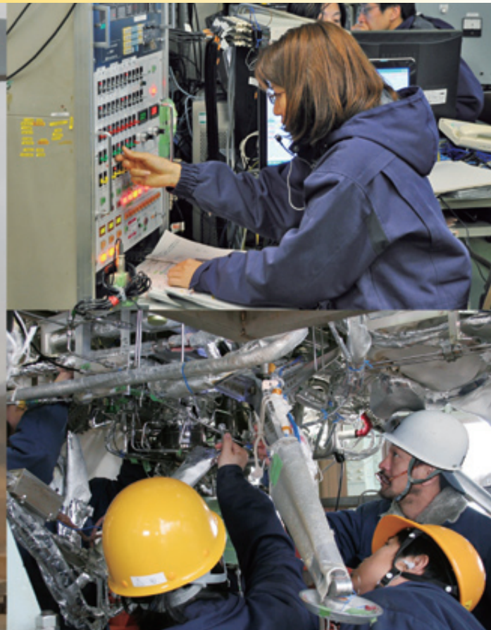
再使用ロケット実験機 (RVT) の地上燃焼試験 (RVT-14)。 右は RVT の操作とエンジンの点検
