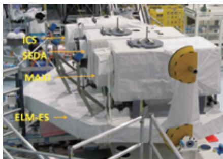
JEM-ELM-ES（曝露部実験用補給部）にセットされたMAXI、SEDA、ICS。この状態で曝露部と一緒にエンデバーに搭載される。ケネディ宇宙センターにて。
