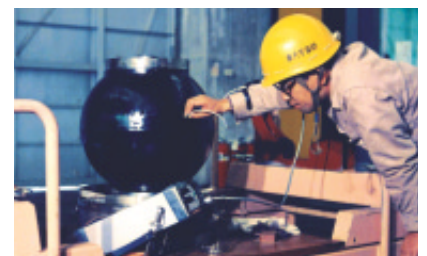
球形モータのはく離を調べる非破壊検査
