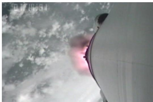
図1 1/2段分離直前のM-Vロケット6号機。このときの高度は約40kmで、気球到達高度とほぼ同じ。
