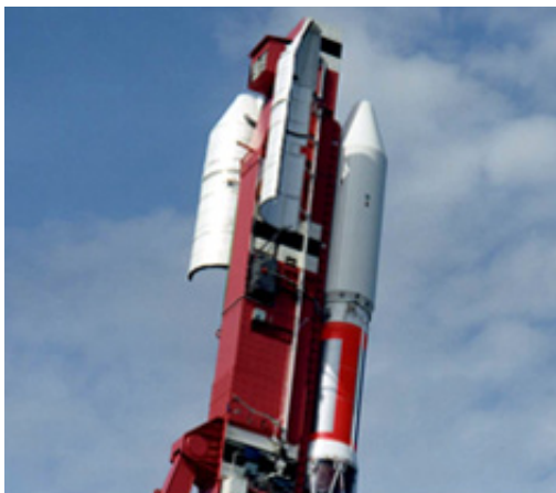
発射寸前まで頭胴部を冷やした冷却用カバー（ランチャーに取り付けられた白いカバー）
