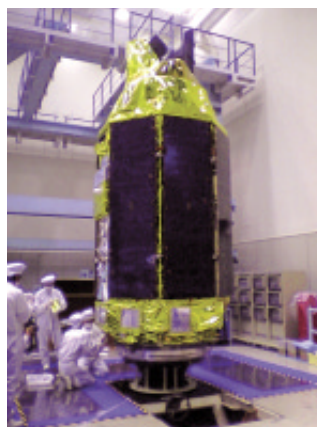
筑波宇宙センター 4.5トン質量特性 測定装置に設置さ れたASTRO-E II 衛星(2005年5月 19日撮影)
