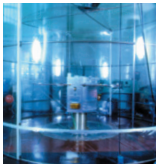
ブースの中にヘリウムガスを入れての動釣合試験
