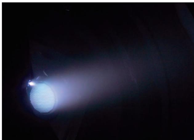
図1 真空チャンバーの中で運転中のイオンエンジンフライトモデル
