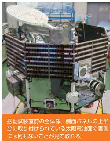
付けられています。この部分の温度をできるだけ下げするために太陽電池が取り付けられている部分の裏側は放熱面となっており、搭載観測機器などは太陽電池面の下端より下の部分、上部デッキと下部デッキの間の約30cmの空間にほとんどすべてのものが搭載されているためです。
