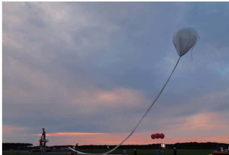
図1 スライダー放球装置とカラーを用いた放球 膨らんでいる気球の根元がカラーで締め付けられているため、気球が広がらず、風の影響を受けにくくなっている。
