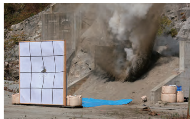
図2 小型搭載型衝突装置 (SCI) の実爆試験の様子 画面左から発射された銅球殻が標的の中央を貫通して右側の砂山に衝突した瞬間。
