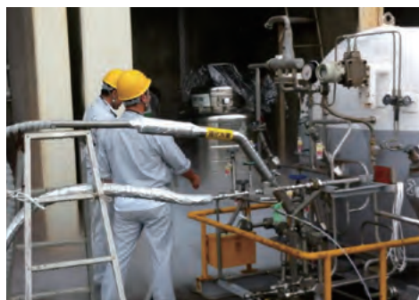
実験装置への充填作業 （右から液体水素容器、液体ヘリウム容器および水素ガス）
