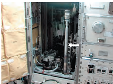
温度勾配炉の試料交換装置に取り付けられた実験後のカートリッジ（矢印）
