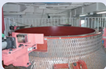
万一のときにロケットのお尻(後部フランジ)を支持する機体転倒防止装置(4ヶ所)
