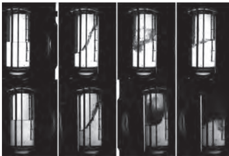
図2 液体水素／液体酸素のスロッシング可視化試験
