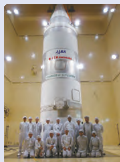
音響試験を行ったイプシロンロケットのフェアリング
