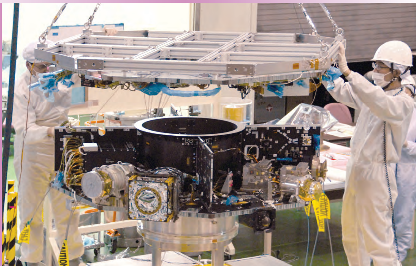
BepiColombo MMO（水星磁気圏探査機）衛星上部・下部結合作業風景
