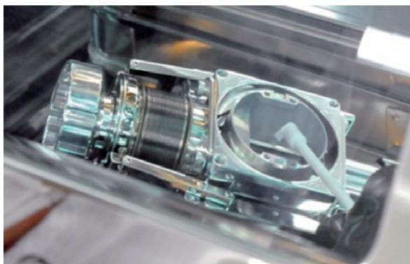
クリーンチャンバー第2室内で，サンプルキャッチャーA室から特殊形状のテフロン製ヘラによって，試料回収を実施している様子。
